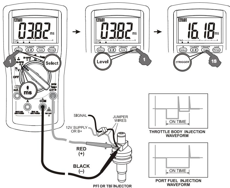
Trigger niveauet er fra fabrikken sat til 3. Tryk på **Level (RANGE)** knappen flere gange for, at vælge et andet trigger niveau. Hvis omdrejnings (RPM) aflæsningerne bliver ustabile, skal der vælges en lavere følsomhed for, at undgå elektrisk støj. Hvis aflæsningen viser 0, vælg da en højere følsomhed. Antal af markørpunkter bruges til, at indikere den valgte følsomhed.
