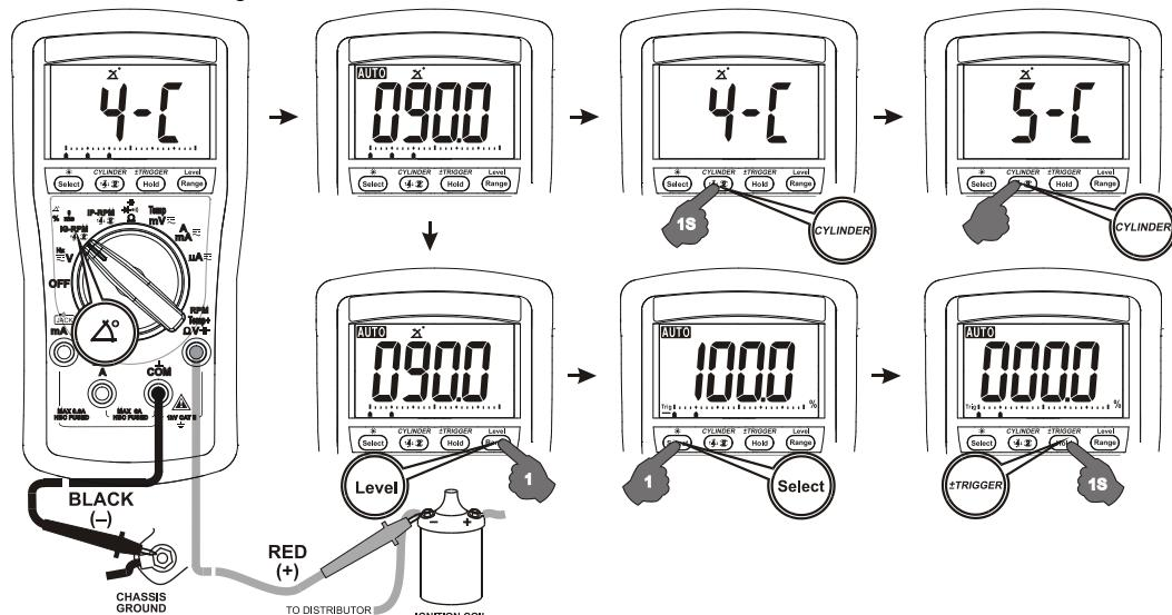
Fra fabrikkens side er antallet af cylindre indstillet til 4 cylindre. Tryk på "CYLINDER" i 1 sek. for, at komme ind i cylinderopsætningen. Tryk på knappen igen for, at vælge antal cylindre fra 1 – 12. Juster DWELL vinklen i henhold til procedurer beskrevet i køretøjets servicemanual.
