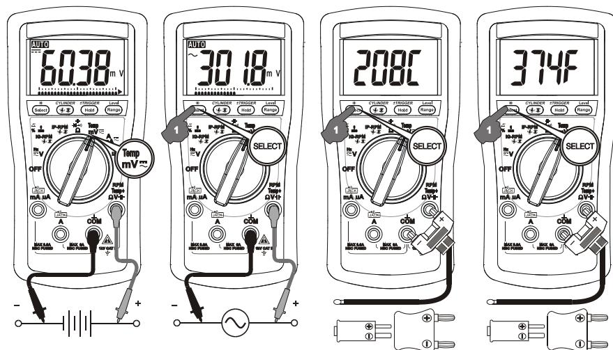
**Not:** Var säker på att du kopplar in banankontakten med typ K temperaturproben med korrekt + polaritet. Du kan även använda adapter Bkb32 (tillbehör) för att ansluta annan modell av typ K-givare.
