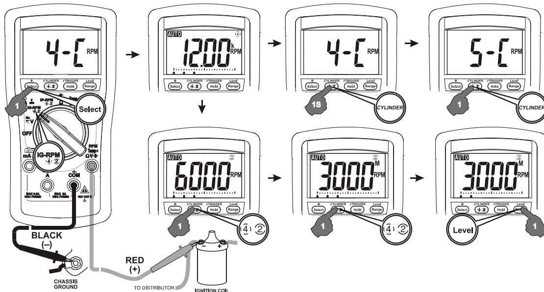
Tryck på  $\text{(\frac{1}{4}, \frac{2}{2})}$  knappen kort för att välja mellan **RPM  $\text{(\frac{1}{4})}$**  för 4-takt, **RPM  $\text{\frac{2}{2}}$**  för 2-takt och DIS, samt **RPM  $\text{\frac{2}{2} M}$**  för special 2-takts waste ignition engine
