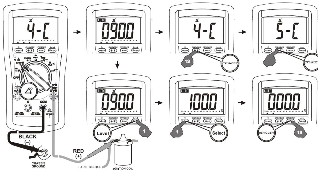
Antalet cylindrar är förinställt på 4 cylindrar. Tryck på CYLINDER knappen i mer än en sekund för att visa cylinderinställningarna och tryck kort igen för att välja antalet cylindrar från 1 till 12 för att överensstämma med motorn som skall testas. Justera kamvinkeln enligt procedurerna som beskrivs i fordonets manual. Kontrollera tiden om kamvinkeln har justerats.
