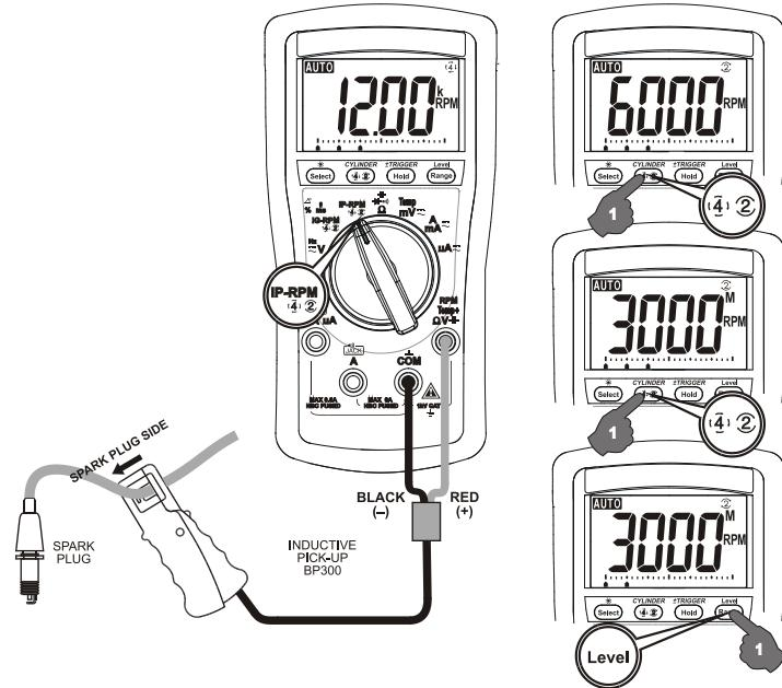
Tryck på  $\frac{1}{4} \frac{2}{2}$  knappen kort för att välja mellan **RPM**  $\frac{1}{4}$  för 4-takt, **RPM**  $\frac{2}{2}$  för 2-takt och DIS samt **RPM**  $\frac{2}{M}$  för 2-takts waste ignition engine
