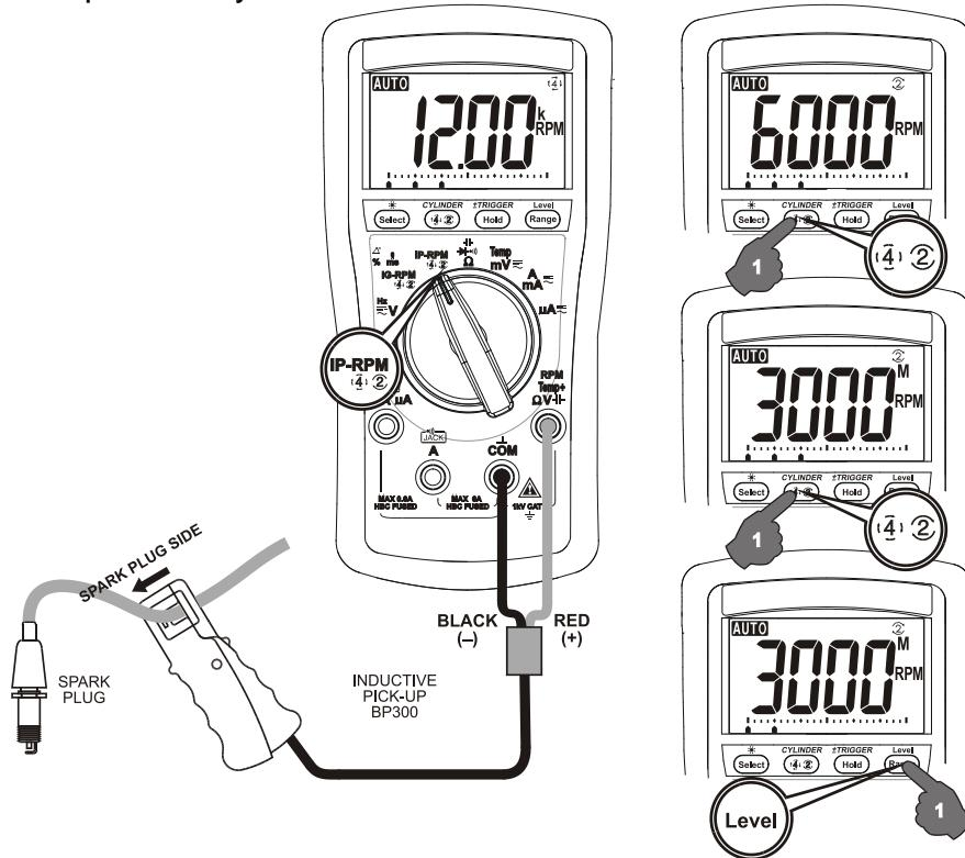
Trigger niveauet er fra fabrikken sat til 3. Tryk på **Level (RANGE)** knappen flere gange for, at vælge et andet trigger niveau. Hvis omdrejnings (RPM) aflæsningerne bliver ustabile, skal der vælges en lavere følsomhed for, at undgå elektrisk støj. Hvis aflæsningen viser 0, vælg da en højere følsomhed. Antal af markørpunkter bruges til, at indikere den valgte følsomhed.
