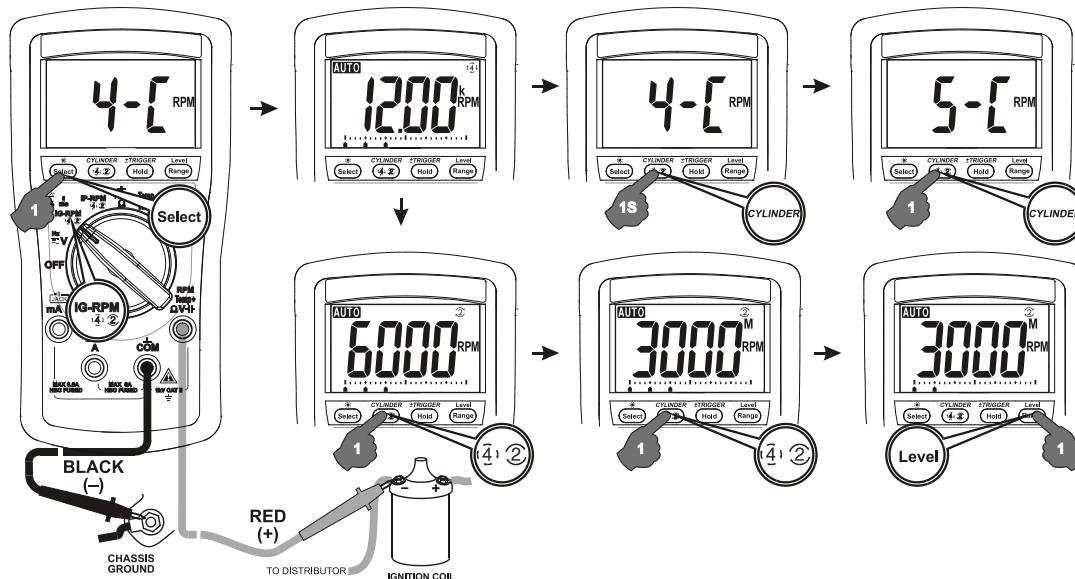
Tryk på **①②** knappen flere gange for, at vælge **RPM<sup>①</sup>** for 4-cylinder, **RPM<sup>②</sup>** for 2-cylinder og DIS og **RPM<sup>③</sup> M** for speciel 2-cylinder 2-taks motor.
